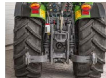
El elevador hidráulico pendular en las variantes V/F va conectado delante del eje trasero. Los brazos inferiores con anchura regulable y los ganchos permiten realizar un ajuste sencillo para adaptarse a cualquier apero.
