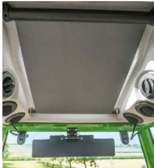
■ El amplio parasol de la ventana del techo protege de la deslumbrante luz solar.
