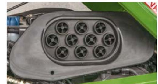
Filtro de alto rendimiento para una gran capacidad de separación en condiciones difíciles.
