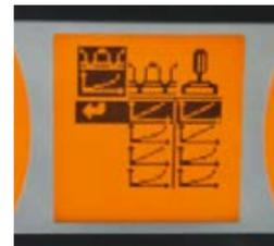
■ La sensibilidad de las válvulas de control hidráulicas puede ajustarse fácilmente en la pantalla.
