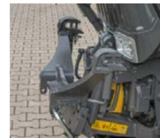
Los brazos inferiores del sistema hidráulico delantero totalmente integrado pueden plegarse de forma compacta en unos pocos pasos. El compacto diseño hace que el 200 Vario sea especialmente maniobrable incluso con un apero delantero.
