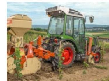
Montaje entre ejes para un uso eficiente de combinaciones flexibles de aperos.
