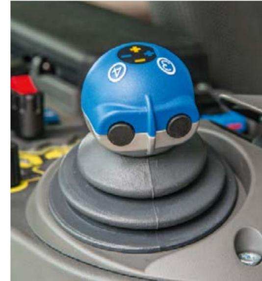
■ El tercer y cuarto circuito de control se activa cómodamente con un pulsador o interruptor en la palanca monomando en cruz eléctrica.
