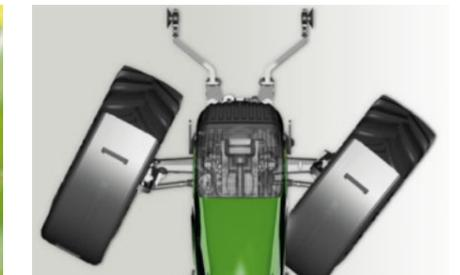
La función VarioActive le permite realizar un solo giro de tope a tope.
