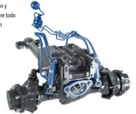
La protección del suelo es una combinación de muchos factores: elevadores hidráulicos pendulares con un punto de tracción bajo y amplio en la parte delantera, doble tracción y bloqueo diferencial automático, suspensión autonivelante y control de estabilidad en el eje delantero. Tracción óptima en todas las condiciones.
