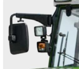
□ Los espejos retrovisores laterales pueden instalarse bajo pedido en versión desmontable.
