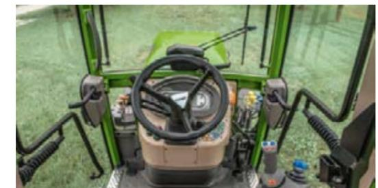
Mantenga una buena visión de los aperos con la gran superficie acristalada y la estrecha columna de dirección. Para trabajar por encima del tractor, por ejemplo, en campos de lúpulo, la ventana del techo ofrece una visión perfecta.
