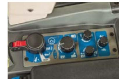
El elevador hidráulico trasero puede ajustarse fácilmente en el panel de mando EHR. El pulsador puede transferirse al joystick multifunción con la función automática.
