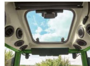
La ventana del techo integrada de serie ofrece la máxima visibilidad para todo tipo de trabajos por encima del tractor. La ventana se abre hacia arriba para la ventilación de la cabina. El parasol protege de la intensa luz solar.
