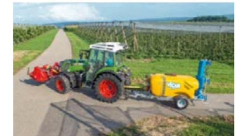
Combinación eficiente de procesos. Con la TdF delantera 540E/750, puede llevar la trituradora a la velocidad de trabajo aunque el pulverizador situado en la parte trasera y el tractor estén funcionando a menos revoluciones.
