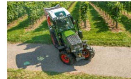
El diseño estilizado de talle de avispa permite un amplio ángulo de giro de hasta 58° y una maniobrabilidad extraordinaria en combinación con el sistema de guiado VarioActive.
