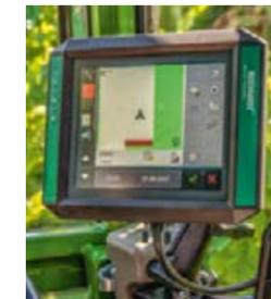
El terminal del sistema de guiado está integrado para obtener el máximo rendimiento y es fácilmente legible.
