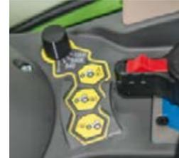
■ La velocidad requerida de la TdF puede seleccionarse cómodamente mediante el mando giratorio.
