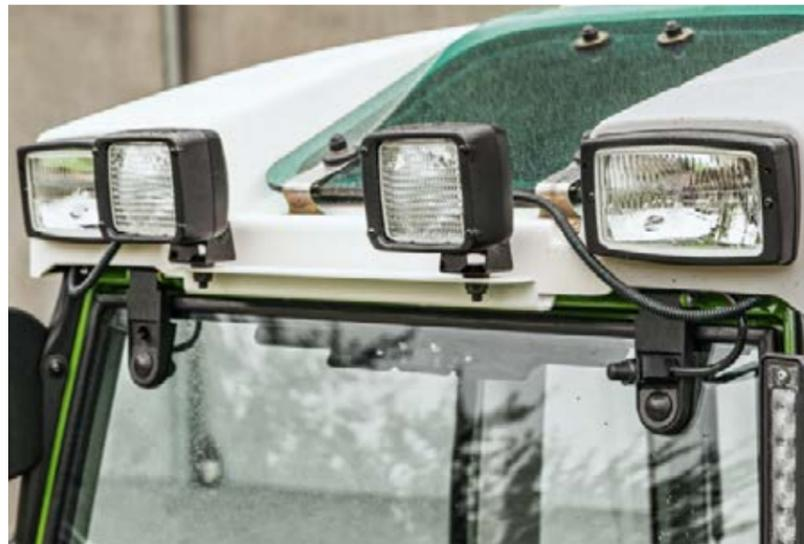
□ También pueden instalarse dos faros de trabajo en la parte delantera en la versión con faros auxiliares.
