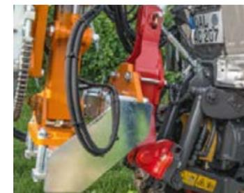
Las placas de montaje integradas en el elevador delantero proporcionan siempre una base estable y segura para aperos frontales pesados.
