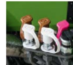
□ El soporte transversal evita que haya latiguillos sueltos sobre el capó.
