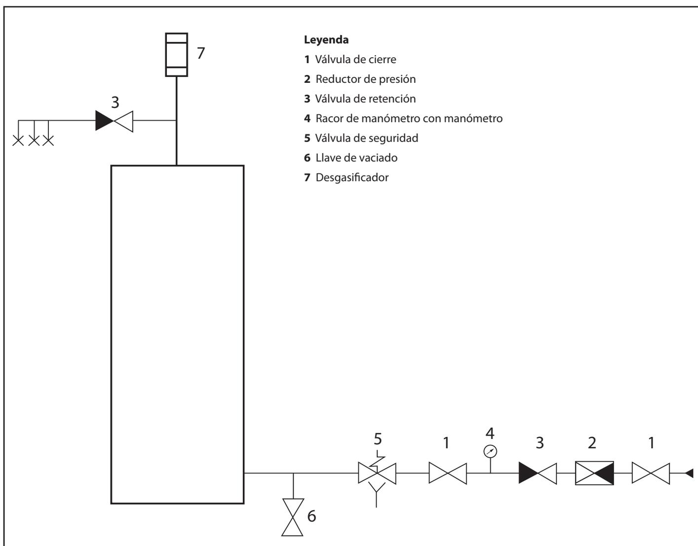
LA INSTALACIÓN HIDROSANITARIA admite las conexiones en la parte delantera o en la parte trasera.
