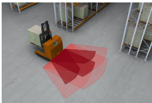
Adaptación flexible de los campos de protección en sistemas de transporte sin conductor (AGVs)
