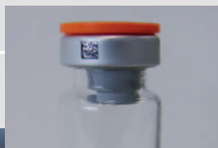
Control de presencia de tapas y lectura de códigos
