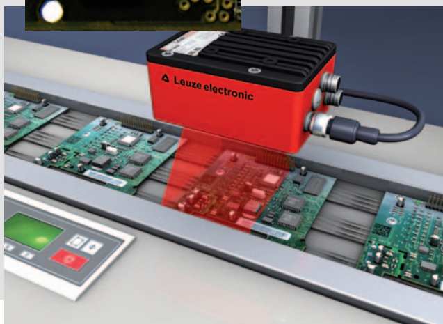
Control de totalidad de componentes y trazabilidad
