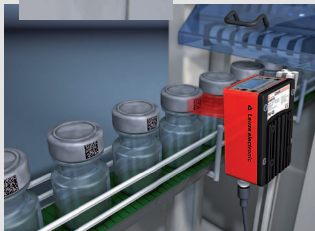
Control de presencia de tapas y lectura de códigos
