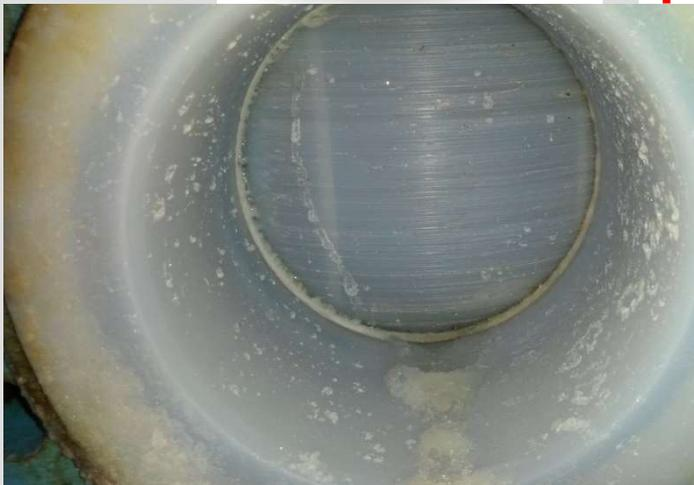
← Válvula metálica revestida erosionada con cristales salinos
