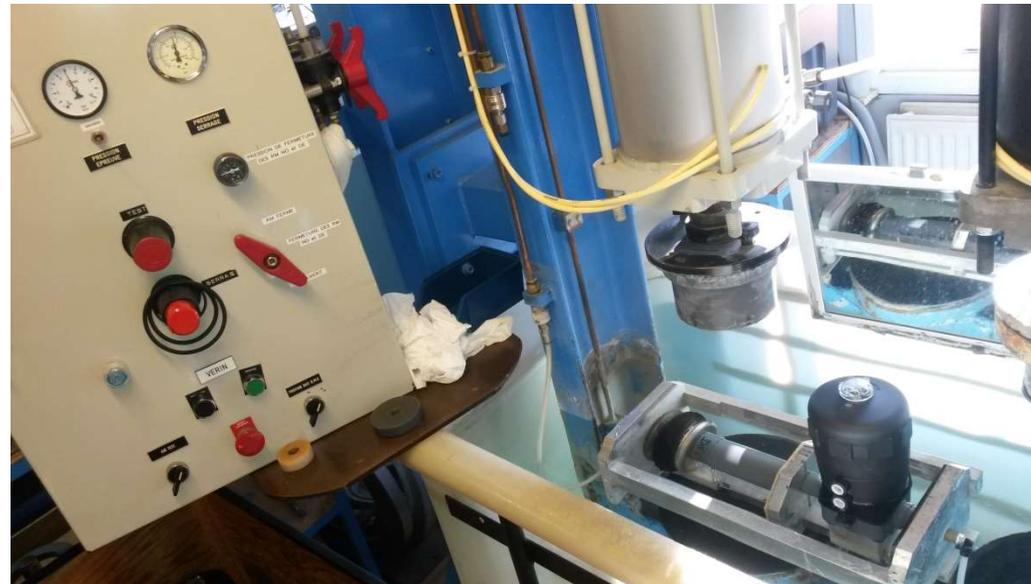
Una test de presión de rotura es realizado en las válvulas usando un control de procesos estadísticos
