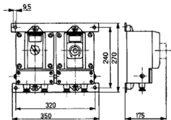
Elementos de mando con carcasa a prueba de presión. Izquierda: dFS20-1 (con interruptor de red). Derecha: dFRW1-1 (con regulador de la amplitud de las vibraciones)
