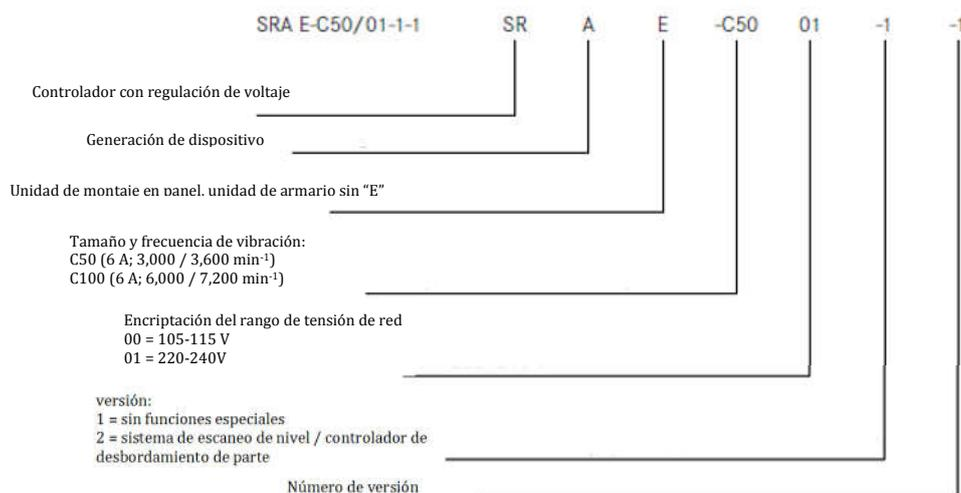
Si los aparatos se van a utilizar en entornos con peligro de explosión, la caracterización del tipo va precedida de una e o de una d, por ejemplo, eSU-B50-1
