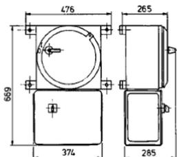
Equipo periférico dSRA... con carcasa a prueba de presión
