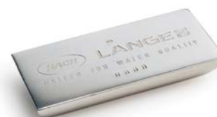
Fig. 20: Barras de plata como resultado de la electrolisis (5) de los residuos de DQO.
