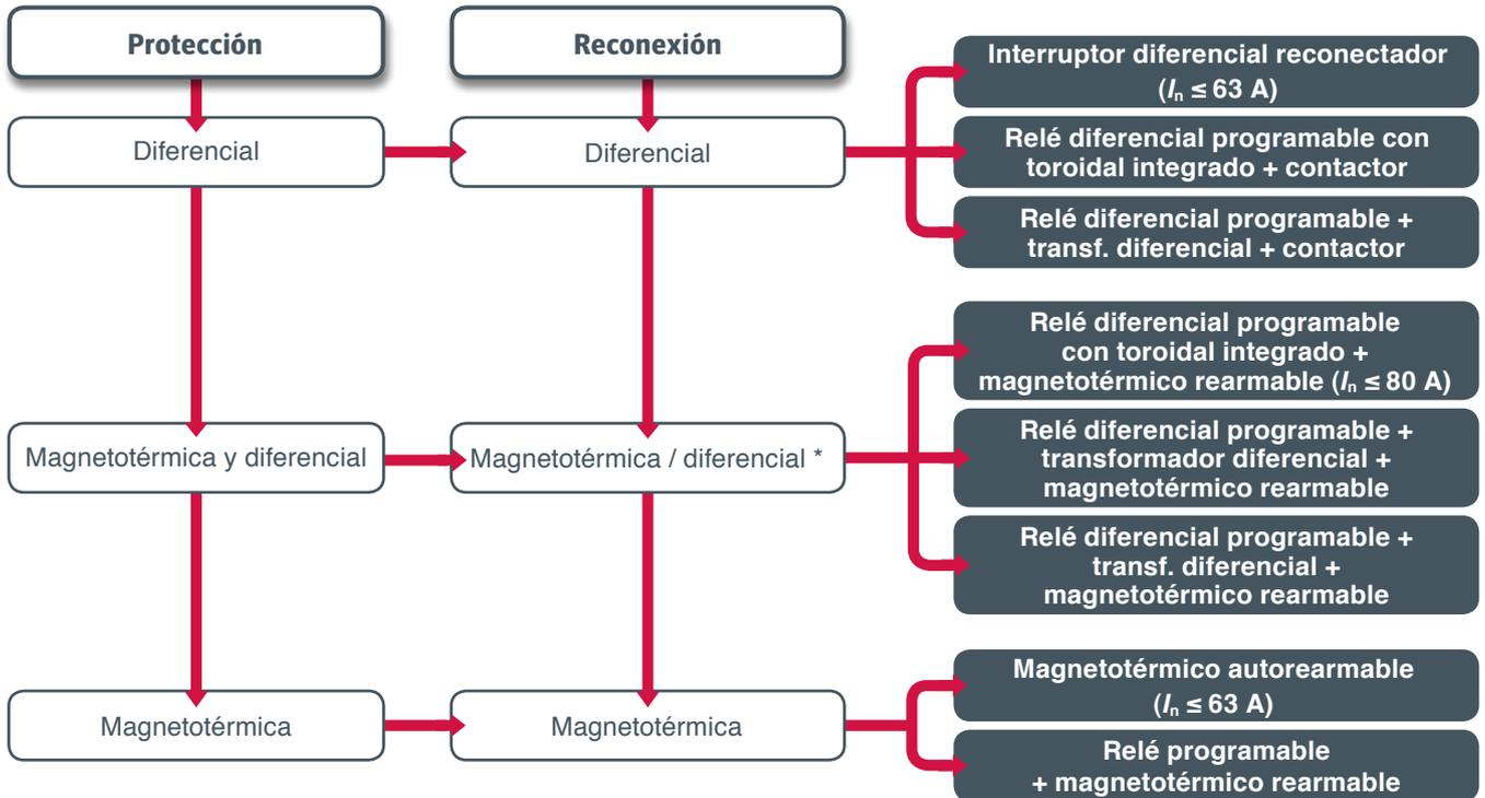
\* Los relés diferenciales programables permiten deshabilitar la reconexión por magnetotérmico
